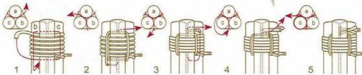
角しばり (角しばりは枠の交差角度を防ぐことに比較的弱いですが、固定点を固着させることは比較的強いです。)
